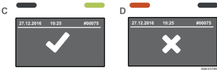
**C)** Ingen alkohol påvist. Testen er bestått. I tillegg vil grønn LED lyse. Etter 2 sekunder er instrumentet klart for bruk igjen.
