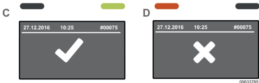
**C)** Ingen alkohol detekteras. Testet är godkänt. Den gröna laman lyser dessutom. Efter 2 sekunder kan instrumentet användas igen.
